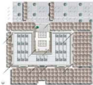
الشكل رقم (01) الموقع العام لمظلات ساحات المسجد الداخلية والخارجية آلية الفتح والإغلاق، وتظل المظلة الواحدة حوالي 57 م 2 .
